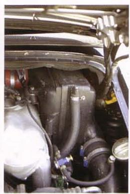
●這部車的空氣芯已經移至引擎室前方，原來的位置則用來擺設水冷Intercooler。
