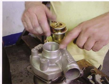
●Ferdinand Pietz先生指出，TTP的渦輪並非完全沿用原廠，以KKK K24為例，TTP將葉片換裝為K26的尺寸，並修改進氣口徑以獲得較大的風量。
