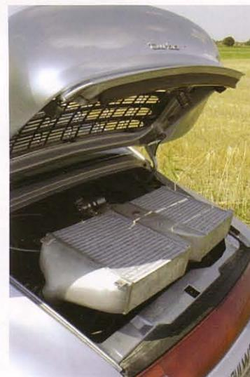
●隨著改裝尺寸更大的渦輪，進排氣系統亦作了升級，進氣冷卻器則改裝尺寸更大的TTP V-Design。
