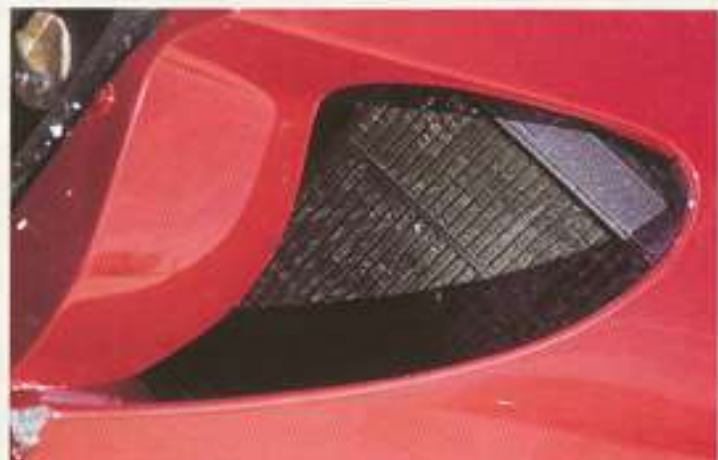
Eisbeutel in den Kühlschlitzen gelten als probates Mittel zur Kühlung im Glutofen des Salzsees
