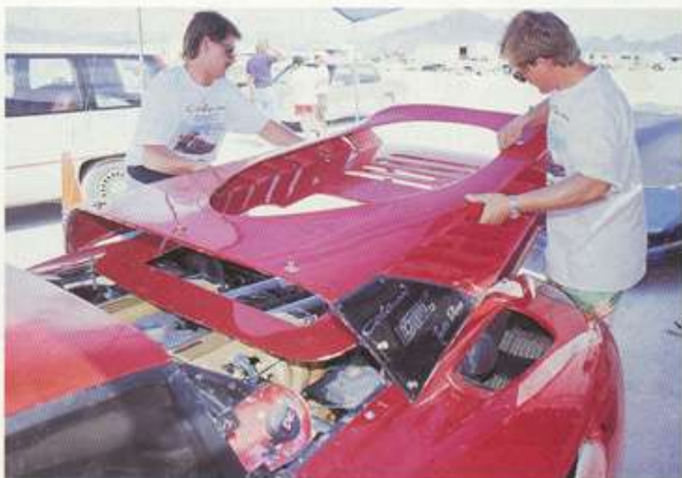
Letzte Vorbereitungen vor dem Start: Andreas Hafner und sein Teamkollege montieren die Motorhaube aus Kevlar
