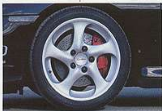
■ Hinter den 18 Zoll großen Porsche-Felgen finden ab Werk 330 Millimeter große Bremsscheiben Platz
