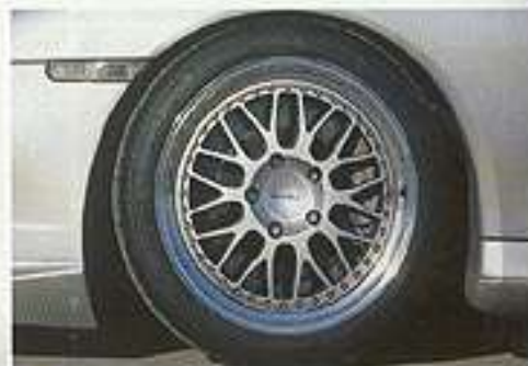
Die Räder des Sportec messen gleichfalls 18 Zoll, die vorderen Bremsscheiben 380 Millimeter
