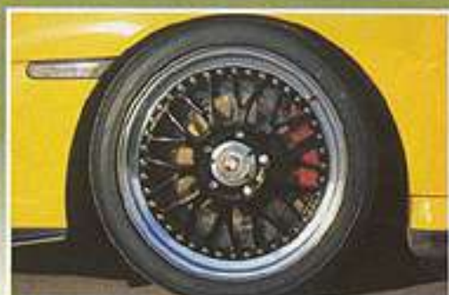
■ Hinter den breiten 18-Zoll-Felgen steckt eine 24 337 Mark teure Achtkolben-Bremsanlage
